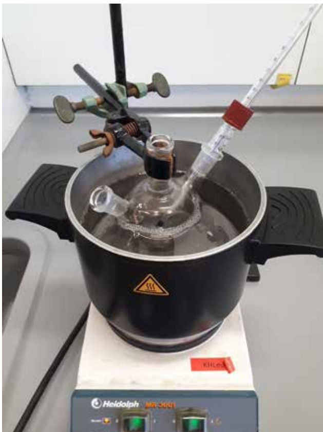
Figuur 1. Foto van de proefopstelling die wordt gebruikt tijdens de synthese van de CdSe-kwantumdots.
