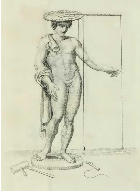
Afbeelding 28 Voorbeeld van een finitorium uit Leon Battista Alberti's, De Statua (Over Beeldhouwkunst) , 1466
